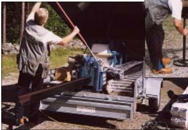
Hängrännan körs ut i rätt längd, anpassad efter Ditt hus och kapas till.
